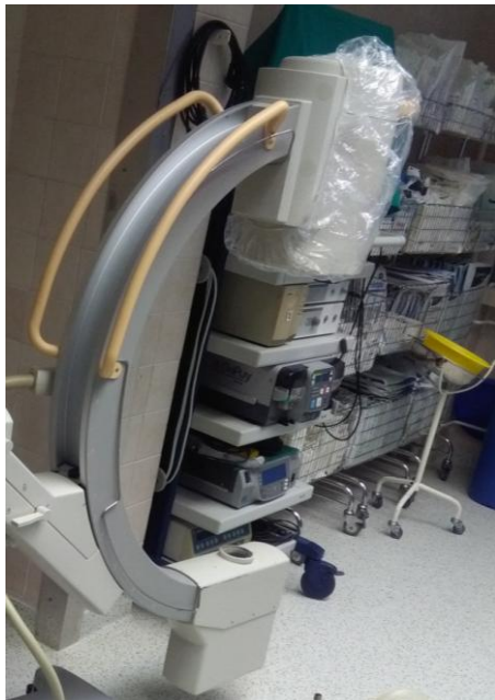
Obr. č. 30: C rameno - RTG mobilný prístroj sterilne krytý, Philips BV Endura (Zdroj: UNB Kramáre, 2017)
